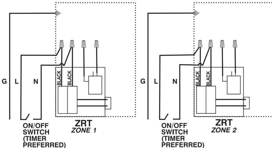
*Fonctionnement continu du ventilateur en utilisant une alimentation de 120 VAC aux bornes ZRT-W2. Les bornes du ventilateur et du ZRT-W peuvent être câblées indépendamment.*
