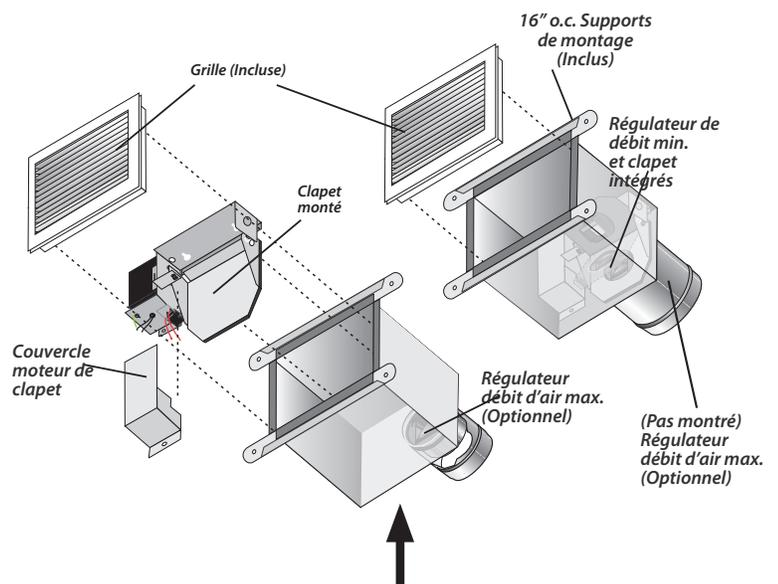
Le débit d'air peut être réglé ou ajusté en tournant le cadran de chaque côté. L'indicateur de débit d'air se déplacera pour afficher le PCM sélectionné. L'étiquette de débit d'air a plusieurs points de consigne définis, mais le mécanisme de réglage unique du CAR3 permet un ajustement infini entre les limites minimum et maximum.
