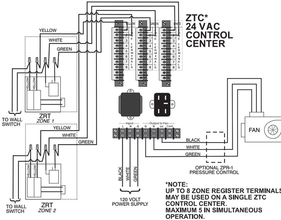
*Fonctionnement intermittent du ventilateur à l'aide du centre de contrôle de borne de zone ZTC 24 VAC et des bornes ZRT-W1. Des interrupteurs de commodité SPST, tels que des minuteries mécaniques ou des déshumidistats à commande manuelle, peuvent être utilisés pour contrôler chaque ZRT-W et ventilateur dans cette configuration. Le ventilateur est contrôlé par le ZTC.*
