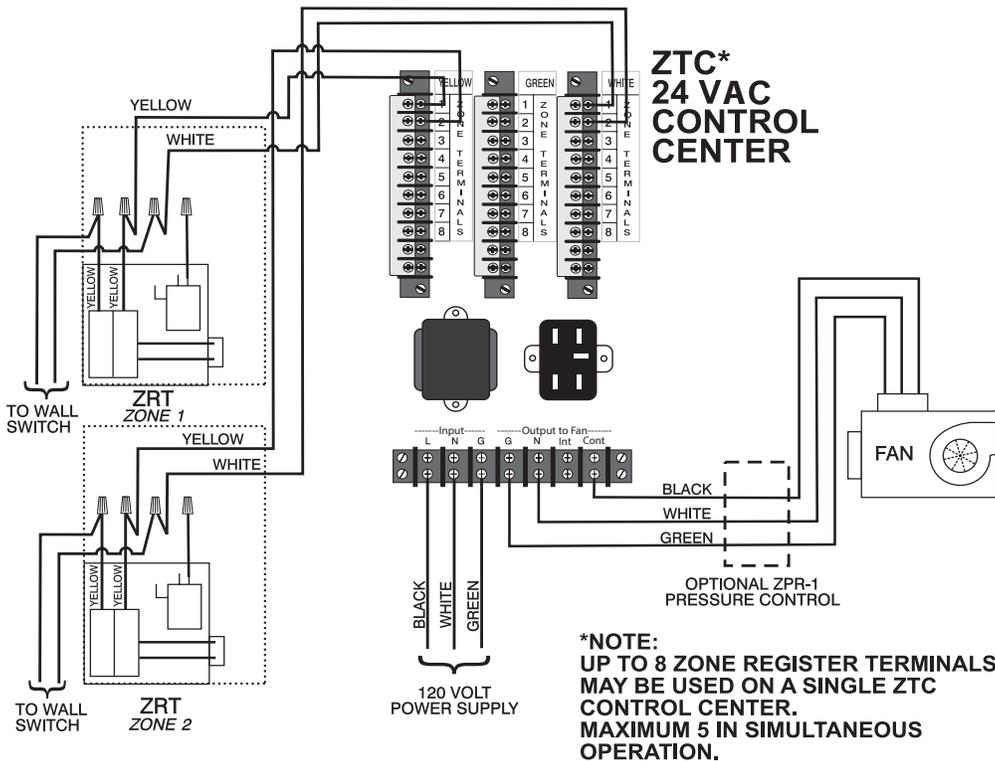
*Fonctionnement continu du ventilateur à l'aide du centre de contrôle de borne de zone ZTC 24 VCA et des bornes ZRT-W2. Des interrupteurs de commodité SPST, tels que des minuteries mécaniques ou des déshumidistats à commande manuelle, peuvent être utilisés pour contrôler chaque ZRT-W dans cette configuration. Le ventilateur peut être câblé indépendamment ou au ZTC.*
