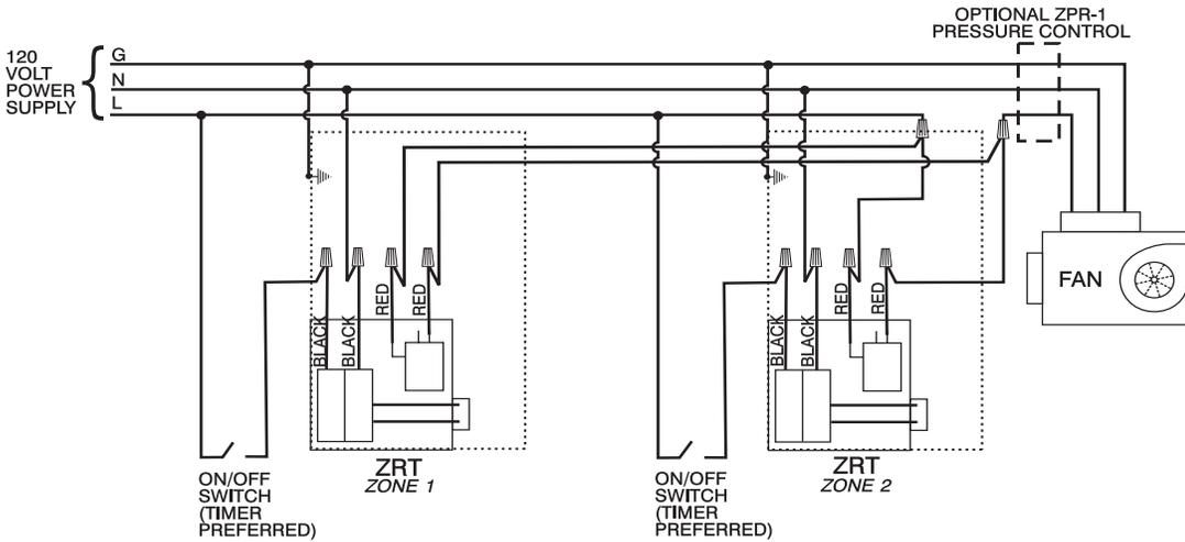
*Fonctionnement intermittent du ventilateur en utilisant une alimentation de 120 VAC aux bornes ZRT-W1. Des interrupteurs de commodité SPST, tels que des interrupteurs à commande manuelle, des minuteries mécaniques ou des déshumidistats, peuvent être utilisés pour contrôler chaque ZRT-W et ventilateur dans cette configuration.*
