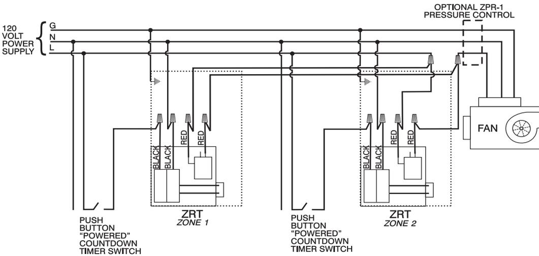
*Fonctionnement intermittent du ventilateur en utilisant une alimentation de 120 VAC aux bornes ZRT-W1. Des interrupteurs pratiques SPST, tels que des minuteries à bouton-poussoir ou des détecteurs de mouvement, peuvent être utilisés pour contrôler chaque ZRT-W et ventilateur dans cette configuration.*
