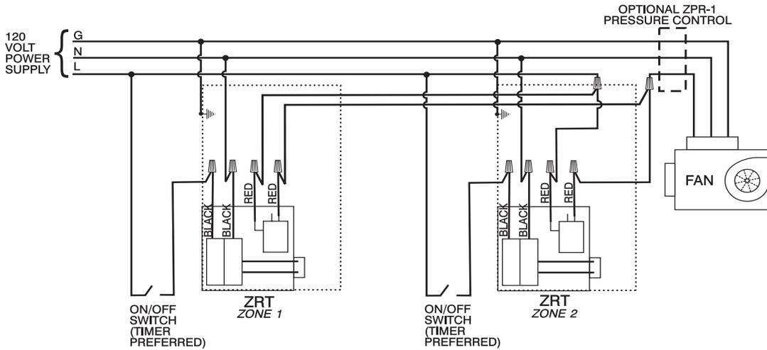
Fonctionnement intermittent du ventilateur en utilisant une alimentation de 120 VAC aux bornes ZRT-1. Des interrupteurs de commodité SPST, tels que des interrupteurs à commande manuelle, des minuteries mécaniques ou des déshumidistats, peuvent être utilisés pour contrôler chaque ZRT et ventilateur dans cette configuration.
