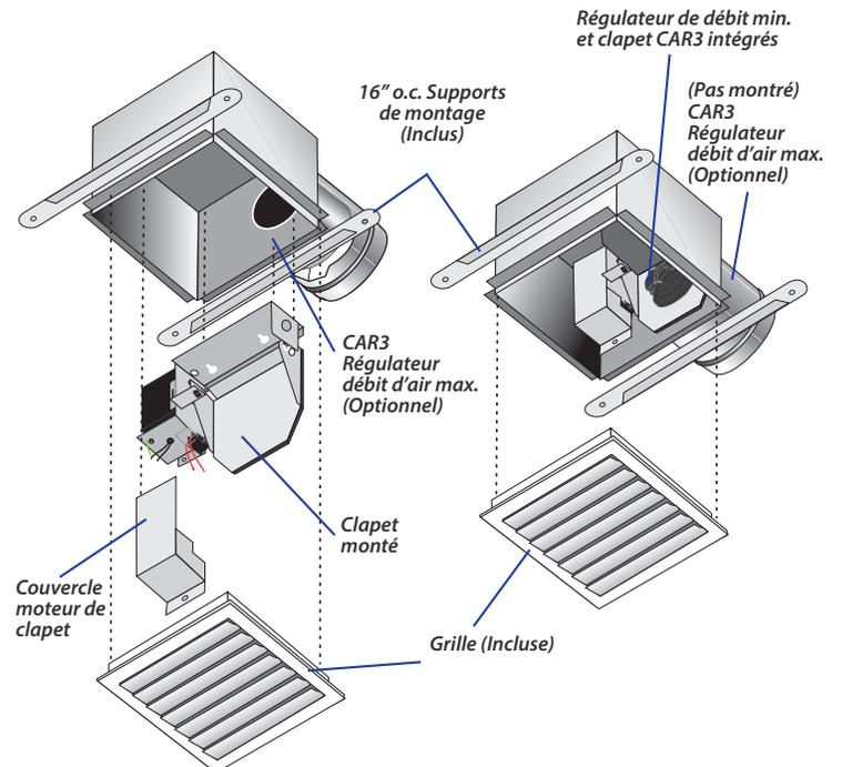
Le débit d'air peut être réglé ou ajusté en tournant le cadran de chaque côté. L'indicateur de débit d'air se déplacera pour afficher le PCM sélectionné. L'étiquette de débit d'air a plusieurs points de consigne définis, mais le mécanisme de réglage unique du CAR3 permet un ajustement infini entre les limites minimum et maximum.
