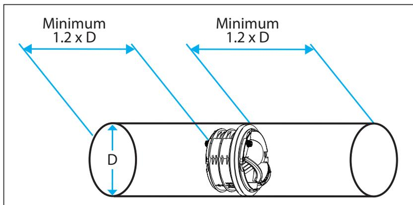
Le régulateur doit être installé dans un conduit d'air métallique comme illustré ci-dessus. D représente le diamètre extérieur maximal du régulateur.
