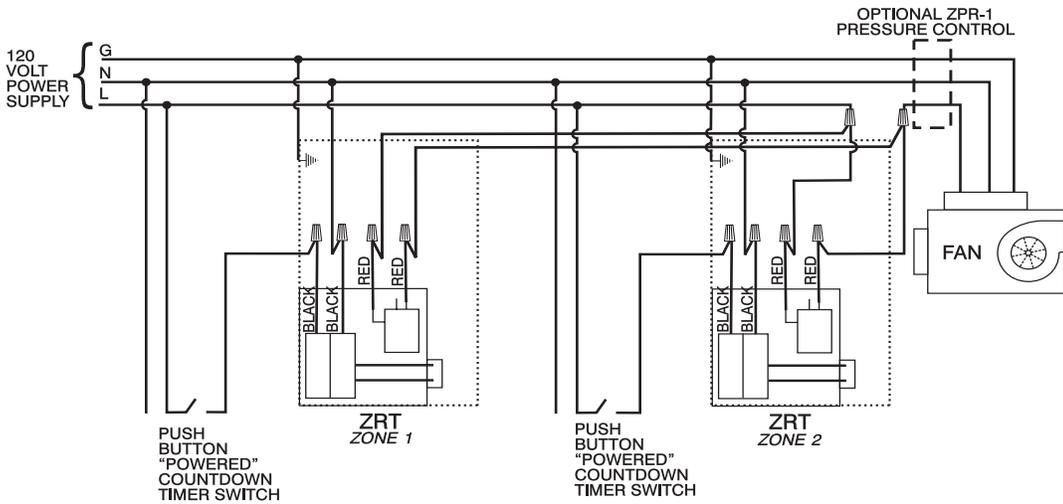
Fonctionnement intermittent du ventilateur en utilisant une alimentation de 120 VAC aux bornes ZRT-1. Des interrupteurs pratiques SPST, tels que des minuteries à bouton-poussoir ou des détecteurs de mouvement, peuvent être utilisés pour contrôler chaque ZRT et ventilateur dans cette configuration.
