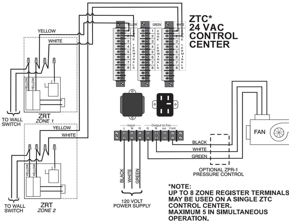
Fonctionnement continu du ventilateur à l'aide du centre de contrôle de borne de zone ZTC 24 VCA et des bornes ZRT-2. Des interrupteurs de commodité SPST, tels que des minuteries mécaniques ou des déshumidistats à commande manuelle, peuvent être utilisés pour contrôler chaque ZRT dans cette configuration. Le ventilateur peut être câblé indépendamment ou au ZTC.
