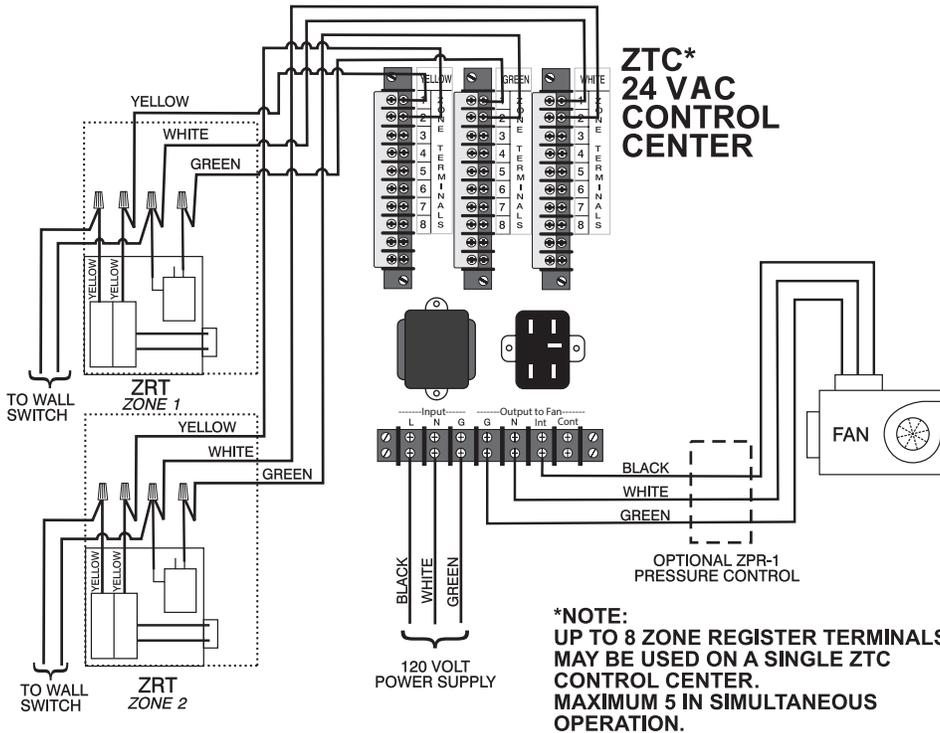
Fonctionnement intermittent du ventilateur à l'aide du centre de contrôle de borne de zone ZTC 24 VAC et des bornes ZRT-1. Des interrupteurs de commodité SPST, tels que des minuteries mécaniques ou des déshumidistats à commande manuelle, peuvent être utilisés pour contrôler chaque ZRT et ventilateur dans cette configuration. Le ventilateur est contrôlé par le ZTC.
