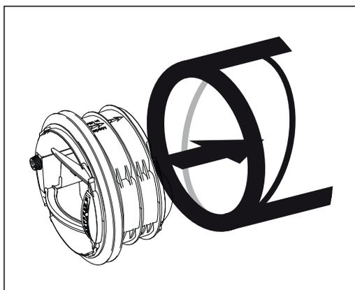
Orientez le CAR3 selon la direction du flux d'air indiquée sur l'appareil. Un montage horizontal ou vertical est acceptable.
