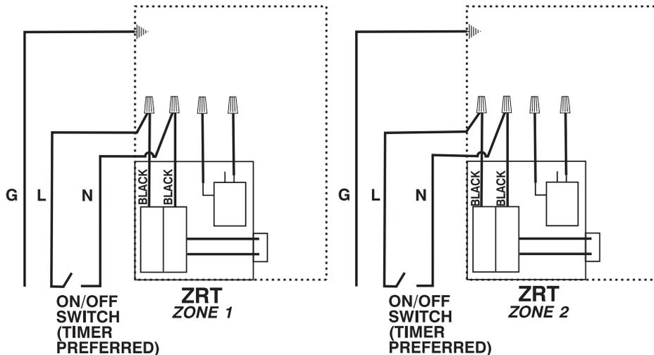
Fonctionnement continu du ventilateur en utilisant une alimentation de 120 VAC aux bornes ZRT-2. Les bornes du ventilateur et du ZRT peuvent être câblées indépendamment.
