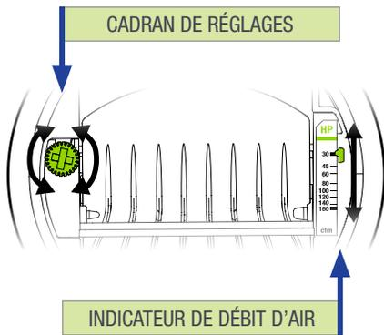
Le débit d'air peut être réglé ou ajusté en tournant le cadran de chaque côté. L'indicateur de débit d'air se déplacera pour afficher le PCM sélectionné. L'étiquette de débit d'air a plusieurs points de consigne définis, mais le mécanisme de réglage unique du CAR3 permet une ajustabilité infinie entre les limites minimale et maximale. L
