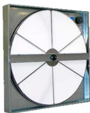
L'échange haut-latent et sensible est excellent pour le contrôle de l'humidité et réduit considérablement les charges de refroidissement dans les environnements à haute HR. Il gère facilement les rendements de récupération en faisant varier le taux de rotation des roues sans changer les débits d'air, il permet des températures de fonctionnement plus basses que les autres technologies.
