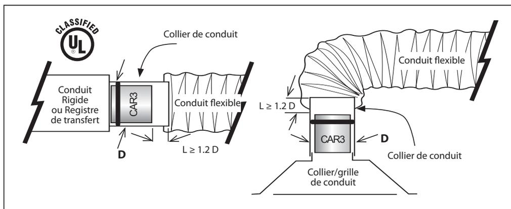
Le CAR3 doit être installé conformément à tous les codes du bâtiment et mécaniques applicables. S'il est installé dans un conduit métallique ou un collier de conduit avec un connecteur de conduit flexible (répertorié selon UL 2043), le CAR3 doit être inséré au moins 1,2 fois le diamètre du conduit à partir du conduit flexible et/ou du connecteur de conduit.
