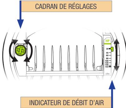
Le débit d'air peut être réglé ou ajusté en tournant le cadran de chaque côté. L'indicateur de débit d'air se déplacera pour afficher le PCM sélectionné. L'étiquette de débit d'air a plusieurs points de consigne définis, mais le mécanisme de réglage unique du CAR3 permet une ajustabilité infinie entre les limites minimale et maximale.
