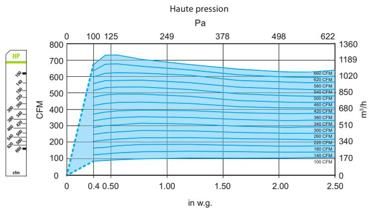
**ZRT-3PDIL-HP- 10" DE DIAMÈTRE (250 mm)**
