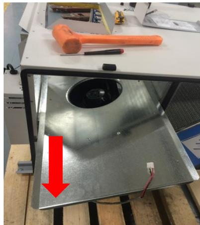
**9 Insérer dans l'unité le cadre d'étanchéité de l'arrivée d'air frais avant l'installation du volet.**
