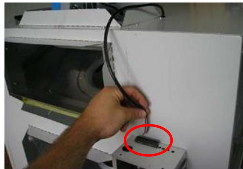
18 Introduire le(s) cavalier(s) sur la carte de contrôle en position indiquées ci-dessous. Utiliser le(s) cavalier(s) fourni(s) dans la trousse.
